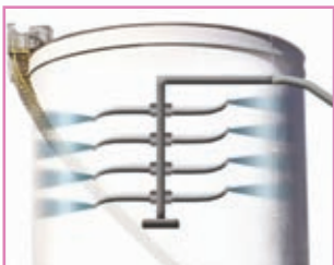
A l'intérieur d'un pétrolier, un arroseur asperge les bactéries à l'intérieur des parois pour décomposer le pétrole.
