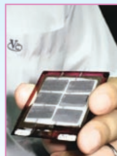
Des cellules solaires organiques développées à la NCTU sont fabriquées avec des films en plastique qui peuvent être montés sur du verre ou un substrat flexible qui peut être plié à la taille d'une poche.
